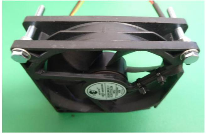
Montiert sind diese beiden Lüfter bei den beiden Luftauslässen. Gesteuert werden die drei Lüfter manuell. Dafür habe ich den Regler für die Instrumentenbeleuchtung kurzgeschlossen und einen Lichtschalter an dessen Platz montiert.
